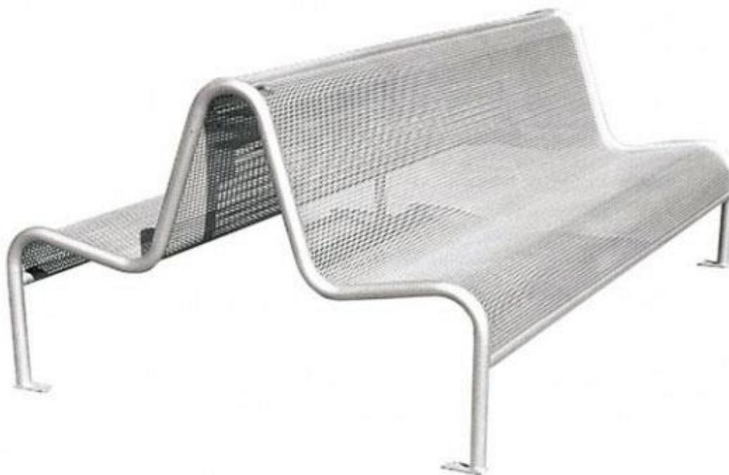
Füße aus 40 mm Stahlrohr, Sitzfläche und Rückenlehne aus 2 mm perforierter Stahlplatte. Perforierungen mit 7 mm Durchmesser.
