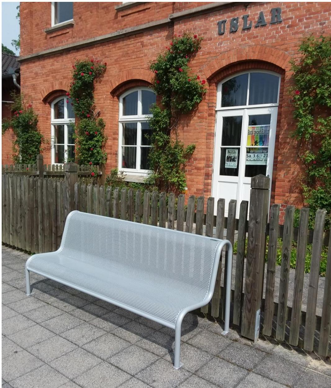
FüÙe aus 40 mm Stahlrohr, SitzfläÙe und Rückenlehne aus 2 mm perforierter Stahlplatte. Perforierungen mit 7 mm Durchmesser.
